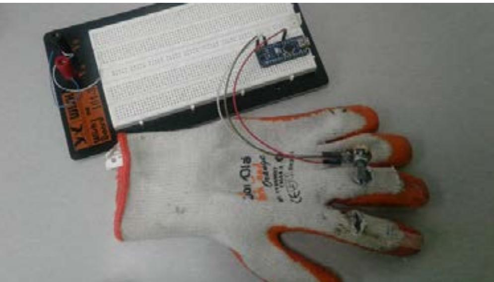
**Imagen 2.** Conexión de potenciómetro al Arduino
